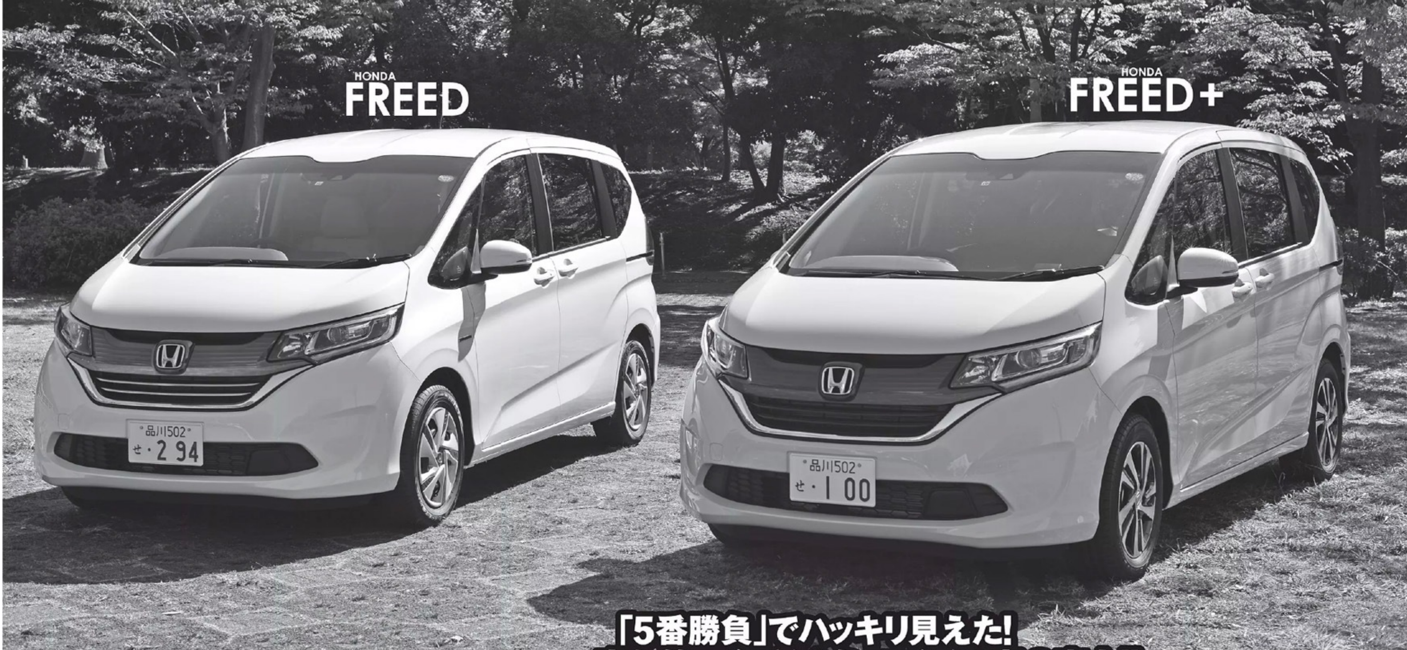
3列ミニバンのフリード(左)と2列のフリード+における(シート数以外の)最大の違いはトランクの床の高さ。フリード+(FF車)のリアゲートはバンパー下までガバッと切られている
