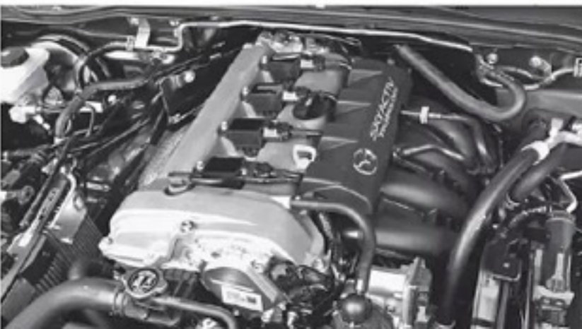
1.5lからファンが渴望した2.0lエンジンに換装。その結果、車両重量は100kgほど重くなっているが、それを全然感じさせない走りを披露した
