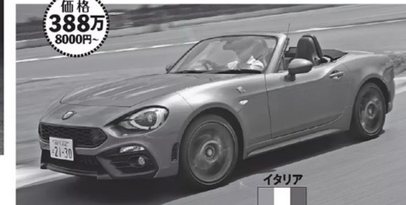
イタリア アバルト 124 スパイダー マツダ・ロードスターの骨格を使い誕生したアバルトのオープンスポーツモデルが、アバルト124スパイダー。1.4ℓの直噴ターボエンジンを搭載し、最高出力は170馬力、最大トルクは25.5kgm
