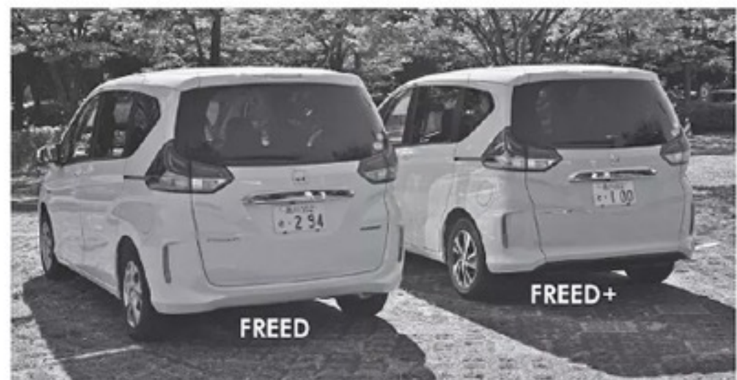
3列ミニバンのフリード(左)と2列のフリード+における(シート数以外の)最大の違いはトランクの床の高さ。フリード+(FF車)のリアゲートはバンパー下までガバッと切られている
